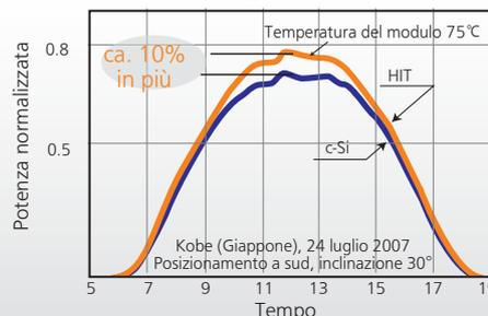
La cella e il modulo HIT presentano un'efficienza di conversione estremamente elevata in caso di produzione in serie
